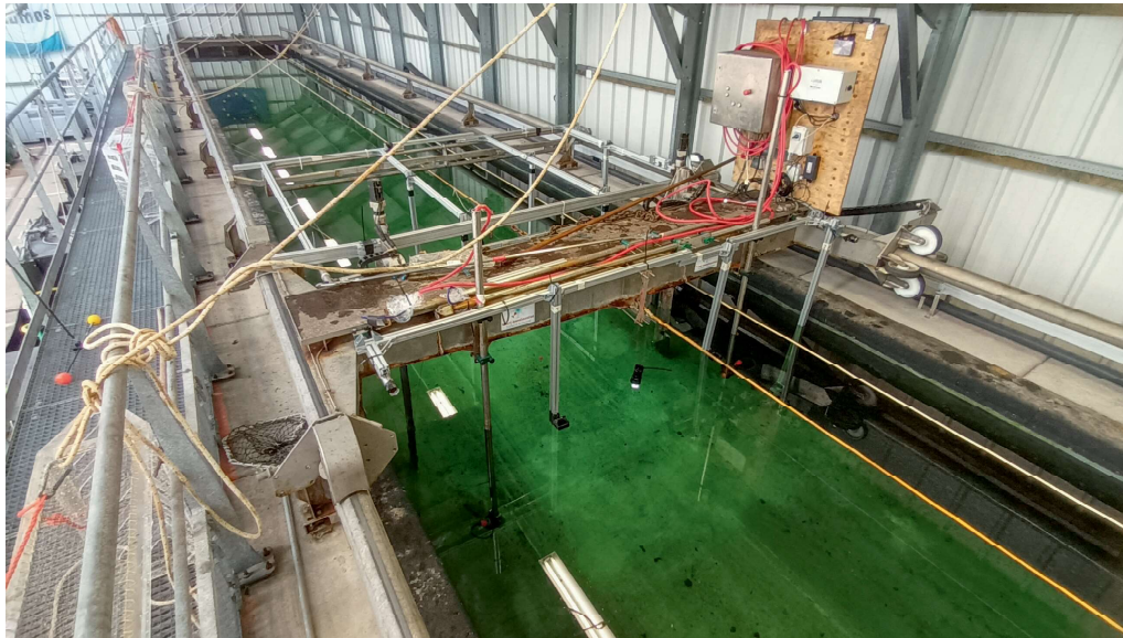
Meetopstelling met negen videocamera's voor de bestudering van het vlucht- en ingraafgedrag van tong en schol in het Visserij Innovatiecentrum in Stellendam. (Foto: Hendrik du Toit, WUR)
